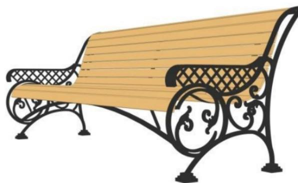
Каркас (Кв.14мм; Полоса мет. 50мм)
